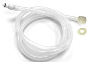
2 tuyaux transparents en silicone de Ø8 x Ø14 mm et de 1,5 m de long avec un raccord à vis 3/8" (joints inclus) pour le raccordement à l'équipement et, à l'autre extrémité, avec un raccord rapide pour le raccordement au bidon.
