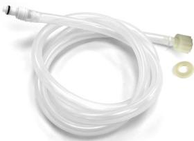
2 tuyaux transparents en silicone de Ø8 x Ø14 mm et de 1,5 m de long avec un raccord à vis 3/8" (joints inclus) pour le raccordement à l'équipement et, à l'autre extrémité, avec un raccord rapide pour le raccordement au bidon.
