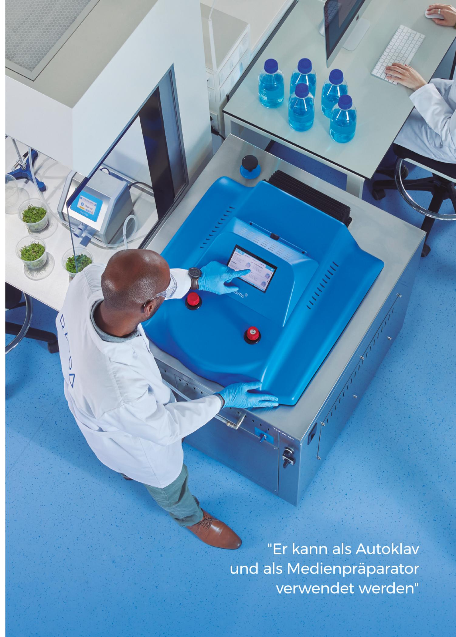
"Er kann als Autoklav und als Medienpräparator verwendet werden"
